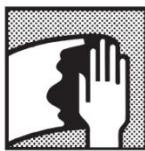
**Черные металлы, сталь:** очистка поверхности, шлифование (удаление ржавчины и слоев окалины), обезжикивание при помощи Очистителя силикона Транслак. Грунтование.
