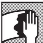
**Черные металлы, сталь:** очистка поверхности, шлифование (удаление ржавчины и слоев окислы), обезжиривание при помощи Очистителя силикона Транслак.
