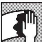
**Черные металлы, сталь:** очистка поверхности, шлифование (удаление ржавчины и слоев окалины), обезжиривание при помощи Очистителя силикона Транслак. Предварительное грунтование эпоксидными грунтами Транслак.
