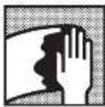
**Черные металлы, сталь:** очистка поверхности, шлифование (удаление ржавчины и слоев окалины), обезжикирование при помощи Очистителя силикона Транслак.
