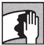
**Черные металлы, сталь:** очистка поверхности, шлифование (удаление ржавчины и слоев окалины), обезжикирование при помощи Очистителя силикона Транслак. Грунтование.
