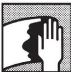
**Черные металлы, сталь:** очистка поверхности, шлифование (удаление ржавчины и слоев окислы), обезжиривание при помощи очистителей силиконов. При необходимости - грунтование.
