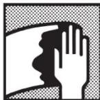
**Черные металлы, сталь:** очистка поверхности, шлифование (удаление ржавчины и слоев окалины), обезжикивание при помощи Очистителя силикона Транслак. Грунтование.
