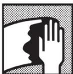
**Черные металлы, сталь, цинк:** очистка поверхности, шлифование (удаление ржавчины и слоев окислы), обезжиривание при помощи Очистителя силикона.
